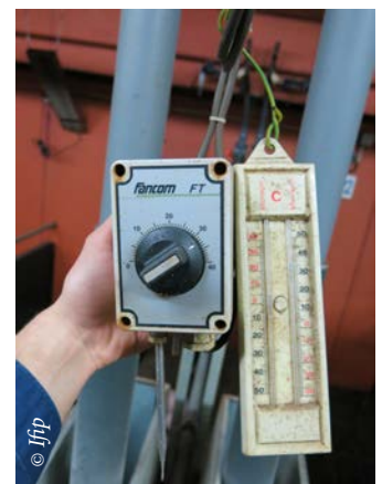
Étalonnage de la sonde de température
