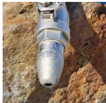
Buse utilisée pour les comparaisons de débit (Ø 9 mm)
