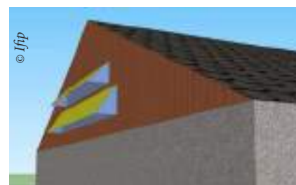
Exemple de surfaces d'ouverture à mesurer lors d'un diagnostic ventilation (surface bleue)
