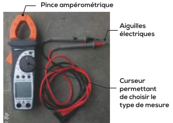
Multimètre avec pince ampérométrique et aiguilles électriques.
