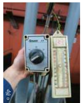
Étalonnage de la sonde de température
