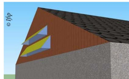
Exemple de surfaces d'ouverture à mesurer lors d'un diagnostic ventilation (surface bleue)
